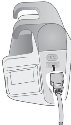
**Figure 10-3 Connexion du capteur SpO<sub>2</sub> à l'appareil X Series Advanced**
