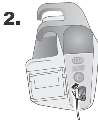
**Figure 9-1** Branchement du connecteur de la tubulure de prélèvement sur la prise CO<sub>2</sub> de l'appareil
