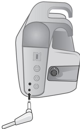
Figure 12-1 Connexion de la sonde de température à l'appareil X Series Advanced
