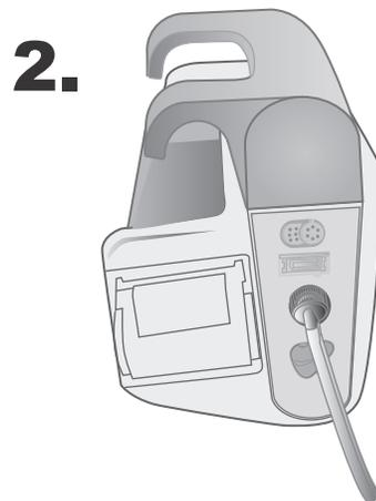
**Figure 8-1 Fixation d'un tuyau à double lumière sur le défibrillateur X Series Advanced**
