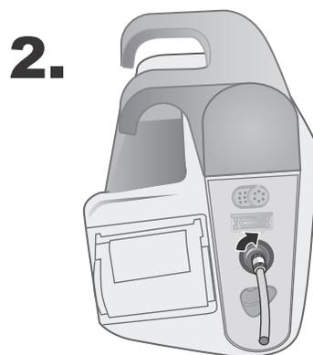
**Figure 8-2** Fixation d'un tuyau à simple lumière sur le défibrillateur X Series Advanced
